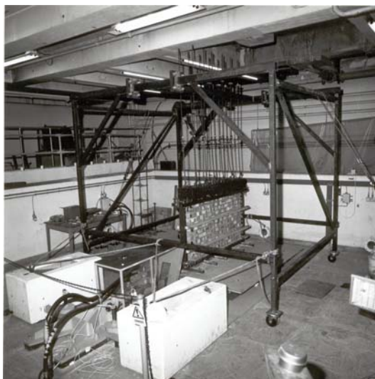
شکل ۱ تصویری از یک دیوار آجری غیرمسلح که توسط نگارنده روی میز زلزله امپریال کالج مورد آزمایش قرار گرفت
